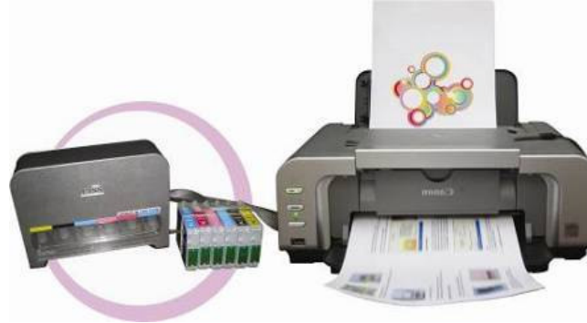
Foto 2. Sistema CISS para la alimentación
